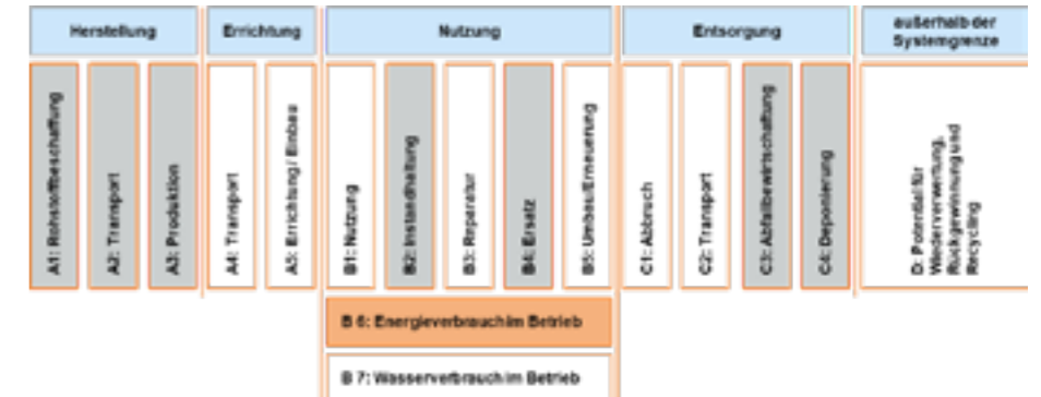
Abb. 2: Bilanzgrenzen der Ökobilanzierung (DIN EN 15804) [4] sowie die Bilanzierungsmodule nach dem Bewertungssystem Nachhaltiges Bauen (BNB) in farbiger Darstellung (orange).
