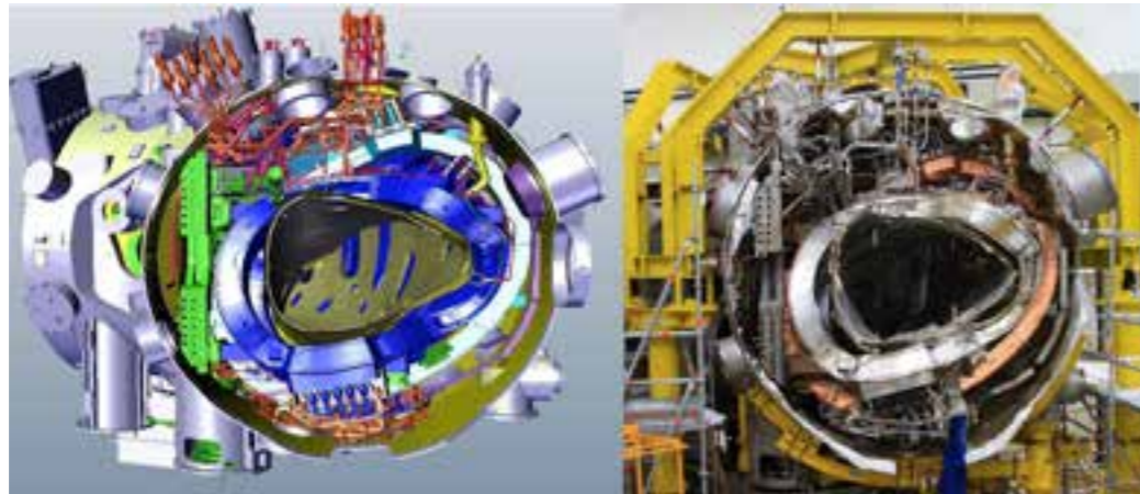
Abb. 2: Ein Modul des Wendelstein 7-X als Computermodell (links) und in der Realität (rechts). Man erkennt gut die nichtplanaren Spulen (links blau, rechts silbern) und die planaren Spulen (links weiß, rechts kupferfarben) im Kryostaten, d.h. dem Volumen zwischen Außengefäß und Plasmagefäß. Ebenfalls erkennbar sind die zahlreichen Stromverteiler und Helium-Versorgungsrohre sowie die innenliegende zentrale Stützstruktur, an der die Spulen mit massiven Bolzen festgeschraubt sind
