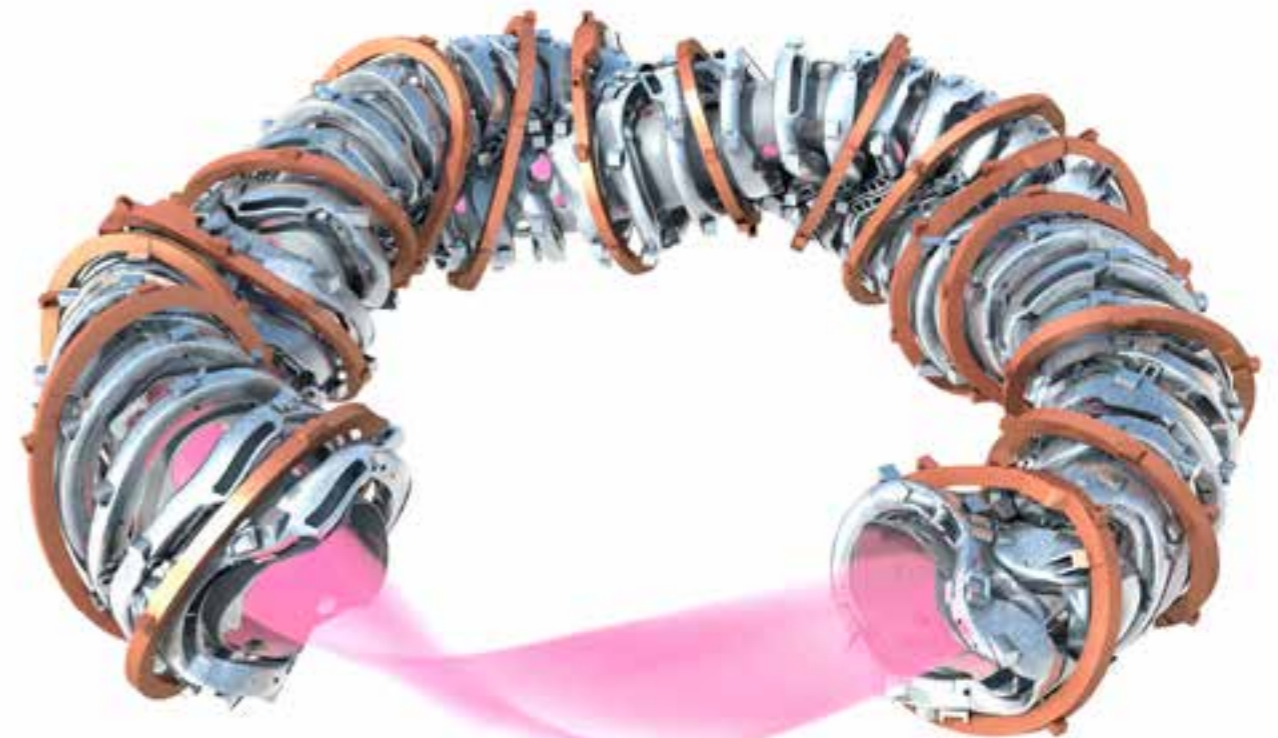
Abb. 1: 50 nichtplanare (silberfarben) und 20 planare (kupferfarbene) supraleitende Spulen erzeugen das Magnetfeld an Wendelstein 7-X für den Einschluss des Plasmas
