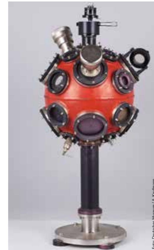
Target-Kammer für Experimente zu Laserplasmen aus dem Zentralinstitut für Optik und Spektroskopie der Akademie der Wissenschaften der DDR. Deutsches Museum Objektsammlungen, Inv.-Nr. 2023-60
