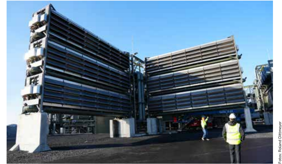
Abb. 3: Sechs der insgesamt 72 Kollektoren der Mammoth-Anlage von Climeworks in Hellisheiði, Island. Die Anlage ist in Betrieb, allerdings noch nicht mit der vollen Kapazität, da erst 12 der Kollektoren aufgestellt und angeschlossen sind. Im nächsten Jahr sollen alle Kollektoren in Betrieb sein
